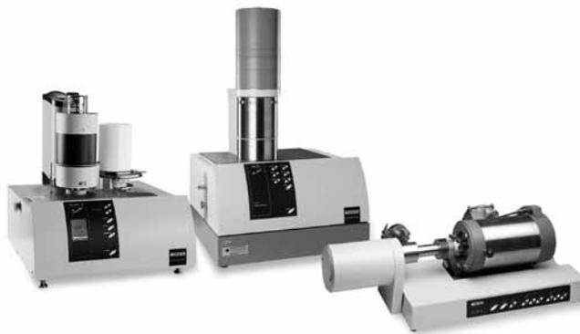
Les instruments Netzsch seront utilisés pour mesurer les propriétés basiques des matériaux ainsi que d'autres propriétés thermophysiques. Ces propriétés incluront les transitions d'ordre 1<sup>er</sup>, 2<sup>nd</sup> et 3<sup>ème</sup>, les coefficients d'expansion et de contraction thermiques, le module, l'énergie d'amortissement, la chaleur spécifique, la diffusivité thermique, la conductivité
